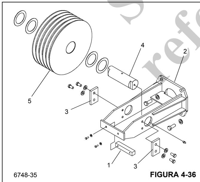
5. Instale el conjunto de la polea (Figura 4-36, 5), el eje (Figura 4-36, 4) y los espaciadores. Instale el eje con la grasea a la IZQUIERDA y las muescas hacia la parte delantera de la pluma.
