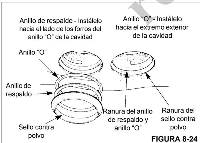
4. Instale los émbolos en la caja. Meta los émbolos por el lado de la caja con los forros. Compruebe que los émbolos estén derechos en las cavidades. Meta cada émbolo en la cavidad hasta que su parte superior quede a ras con la parte superior del sello contra polvo (Figura 8-25).
