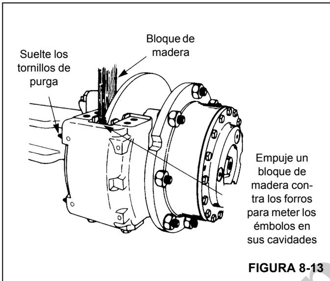
4. Utilice un pedazo de madera como palanca contra los forros para empujar los émbolos hasta meterlos completamente en la caja. Apriete los tornillos de purga (Figura 8-13).
