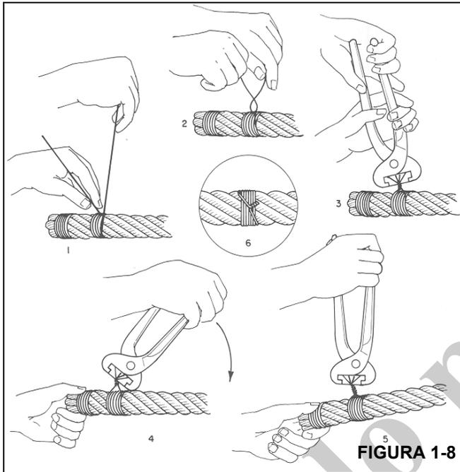
Envuelva un tramo de alambre recocido blando (Figura 1-8) alrededor del cable por lo menos siete veces. Trencé los dos extremos del alambre en el punto central de la sujeción. Apriete la sujeción apalancando y trenzando el alambre de modo alternado. Recorte los dos extremos del alambre y martíllelo hasta dejarlo plano contra el cable.
