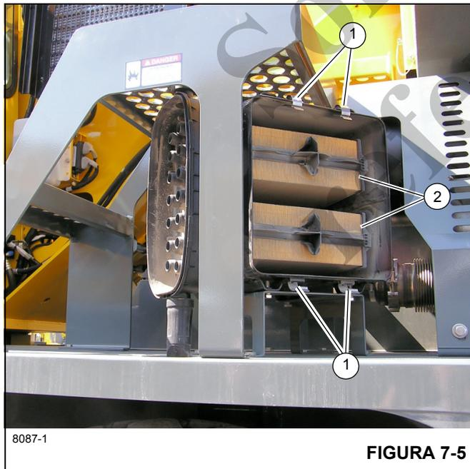
2. Retire el filtro primario (2) (Figura 7-5) del filtro de aire y revíselo en busca de materia extraña y marcas de polvo.
