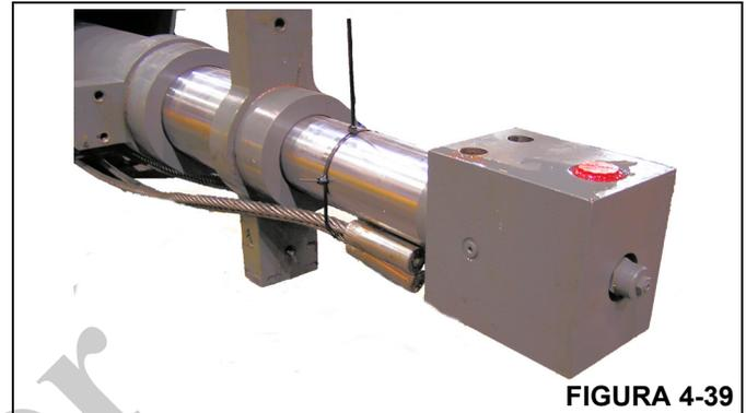
7. Inserte el cilindro telescópico cuidadosamente en la sección de extremo hasta que el miembro soldado de la polea quede libre del miembro soldado del cable de retracción.
