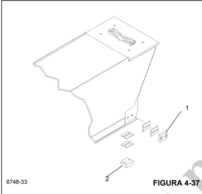
3. Instale la almohadilla de desgaste trasera inferior (Figura 4-37, 2) en la sección de extremo con dos tornillos.
