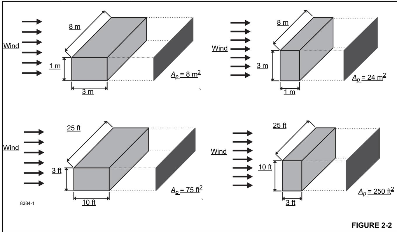
**Determining Wind Drag Coefficient ( $C_d$ )**
