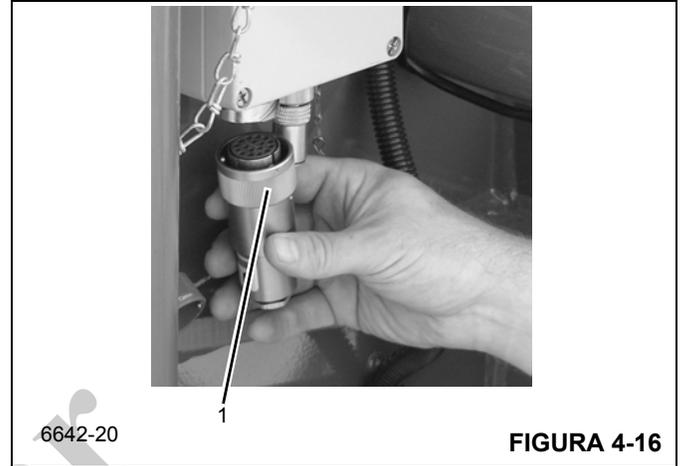
c. Dirija el cable a través de la extensión de pluma y almacene el conector (1, Figura 4-17).
