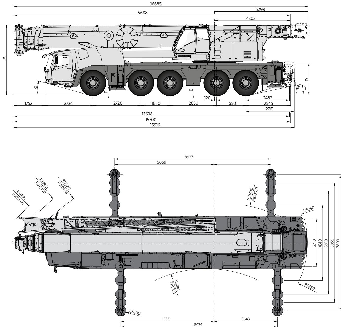
Ra = Radius all wheels steered. • Radius allradgelenkt. • Rayon toutes les roues directrices. • Radio de giro con todas las ruedas giradas. • Raggio di curva con tutte le ruote sterzate.
