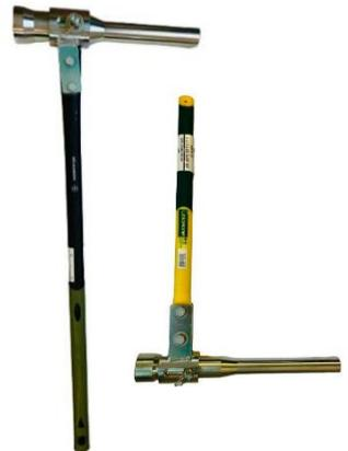
Ce système prévient les risques d'écrasement des mains et les vibrations lorsque les axes sont difficiles à sortir.
