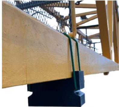
Das Gummiband hält den Keil während der Masthandhabung an Ort und Stelle. Die Höhe des Keils garantiert ausreichend Platz, um die Gefahr von Quetschungen an Händen zu vermeiden.
