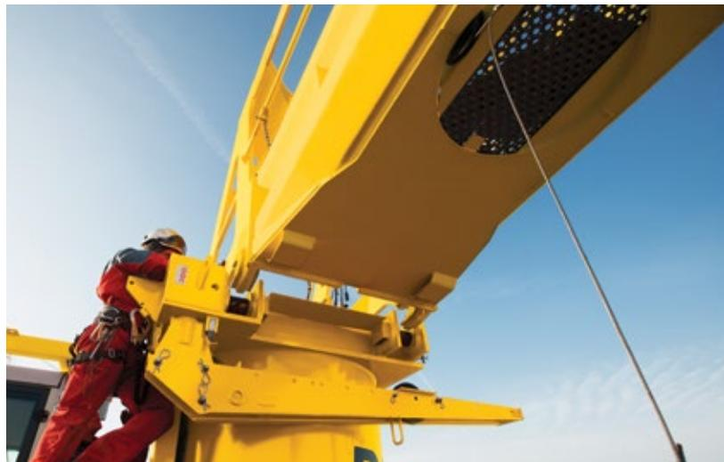
^ Der Standard Kopfanschluß zentriert die Bauteile beim Verbinden des Gegenauslegers mit dem Mast.
