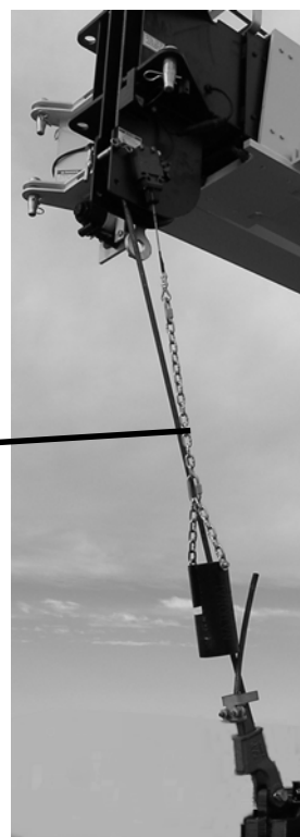
Posición incorrecta de ATB para transporte Peso y cadena de ATB pendiendo del interruptor de ATB
