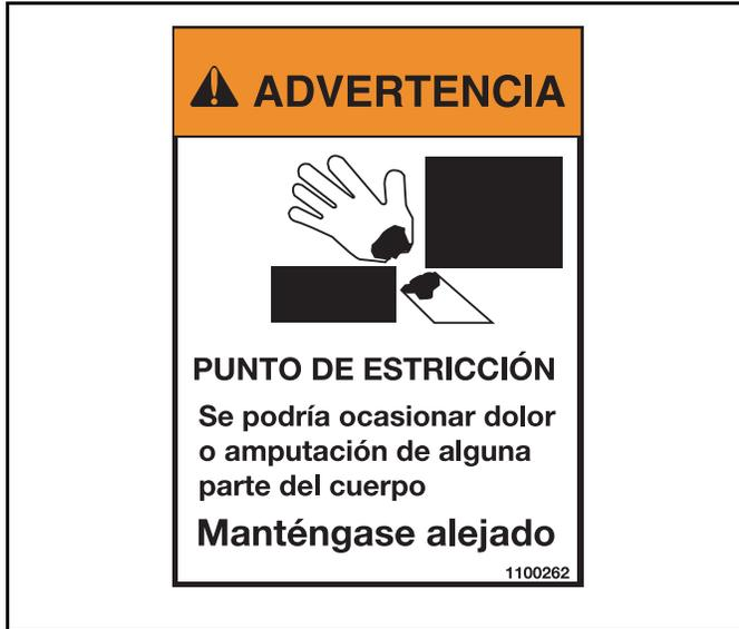
Antes de girar pluma, asegúrese de que haya suficiente espacio en todos lados de la grúa y que no hayan personas cerca del área. Un punto de estricción entre la cabina del operador y el mástil pueden ocasionar lesiones o la muerte.
