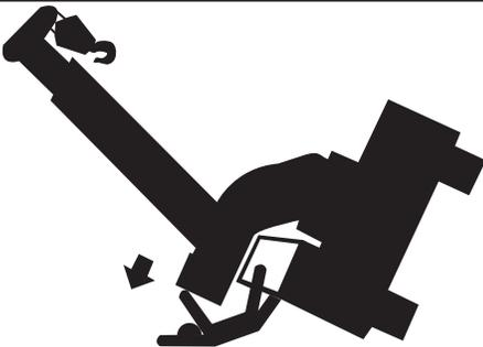
Si se propulsa la grúa en modo de dirección diagonal sin tener la pluma hacia adelante, retraída y bajada, se puede afectar la estabilidad hacia la parte trasera de la máquina y causar el VUELCO DE LA MÁQUINA.
