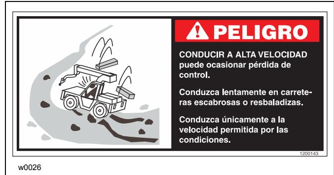
La grúa no tiene suspensión de ejes. Si conduce a velocidades altas, especialmente en superficies escabrosas, la grúa puede rebotar, lo que puede ocasionar la pérdida del control de la misma. Esto podría ocasionar lesiones personales, la muerte y daños a la propiedad. Si rebota, reduzca la velocidad.
