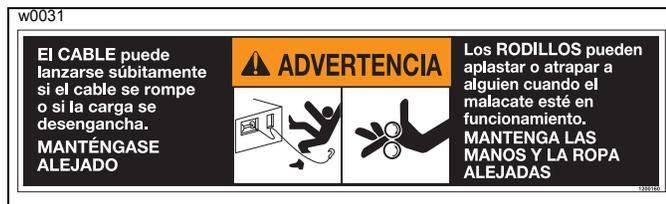
Siempre mantenga las manos y la ropa lejos de los rodillos guiacabos y de la abertura delantera mientras el malacate esté en funcionamiento. Aleje a las personas del área. La rotura del cable o la desconexión del gancho puede causar lesiones o la muerte.
