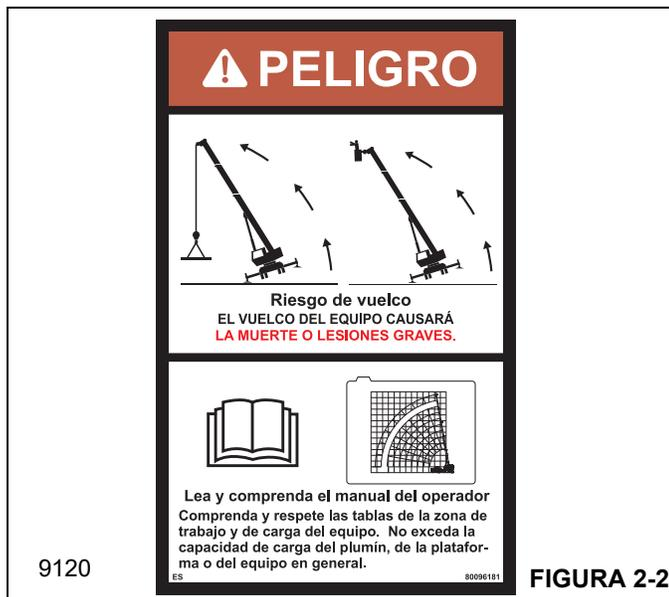
aparejada y fijada apropiadamente al gancho. Revise la *tabla de carga* en comparación con el peso de la carga. Levante ligeramente la carga del suelo y vuelva a revisar la estabilidad antes de proceder a levantarla. Determine el peso de la carga antes de intentar levantarla.
