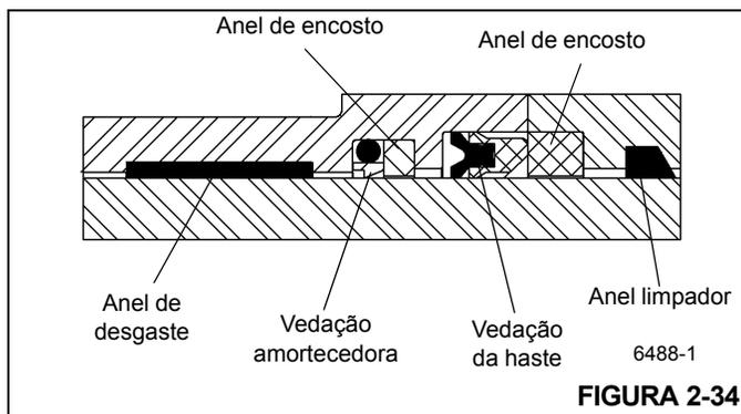
15. Instale o anel de vedação e o anel de encosto na parte externa da cabeça externa do cilindro.
