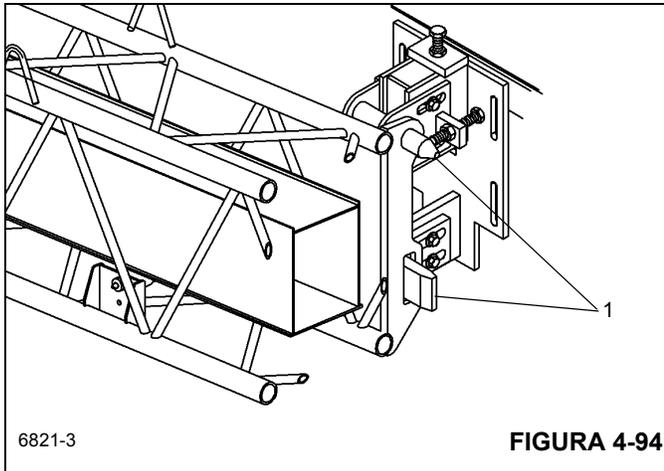
9. Verifique se de que o pino da presilha e o pino do engate (Figura 4-95, 1) foram removidos do suporte de armazenamento traseiro.
