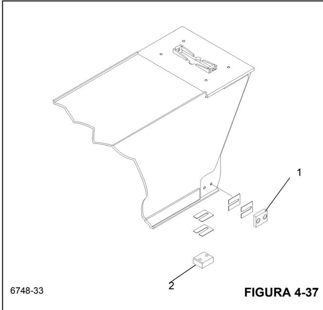
3. Instale a placa de desgaste inferior (Figura 4-37, 2) na seção volante com dois parafusos.
