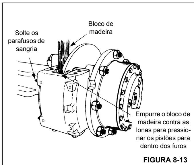
4. Use um pedaço de madeira apoiado nas lonas como uma alavanca para empurrar os pistões completamente para dentro da carcaça. Aperte os parafusos de sangria (Figura 8-13).
