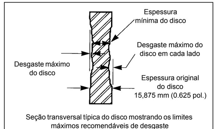
Seção transversal típica do disco mostrando os limites máximos recomendáveis de desgaste
