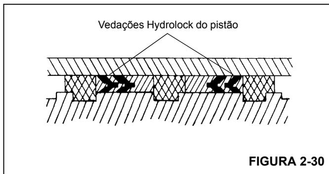
7. Instale as vedações Hydrolock de reposição na parte externa do pistão. Verifique se os dois "vês" nas vedações hydrolock apontam um para o outro (Figura 2-30).
