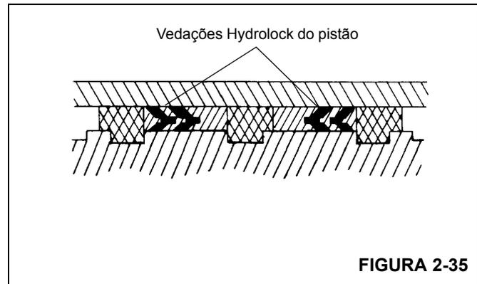
19. Instale as vedações Hydrolock e os anéis de desgaste no pistão (Figura 2-35).
