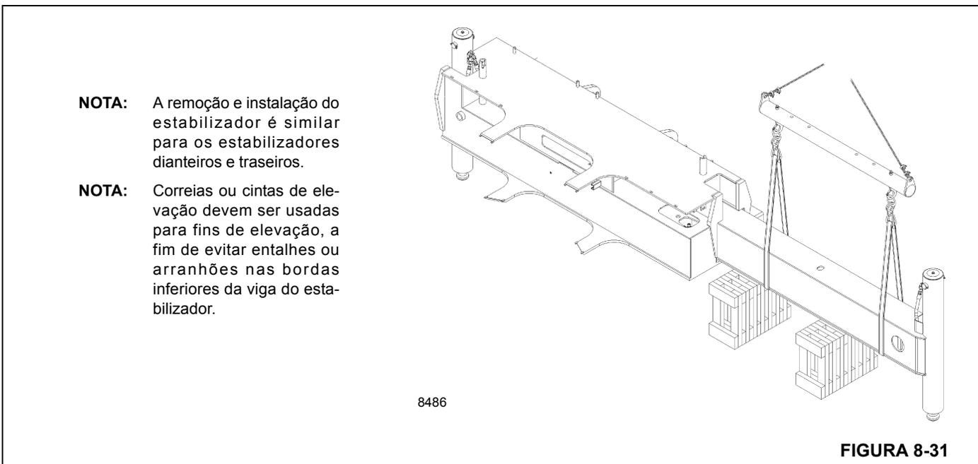
**NOTA:** A remoção e instalação do estabilizador é similar para os estabilizadores dianteiros e traseiros.
