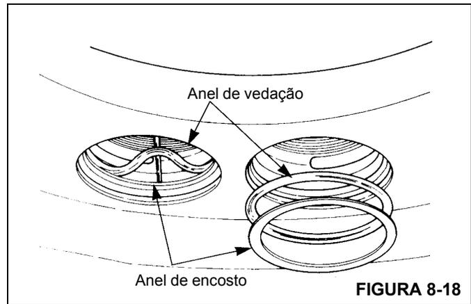
11. Inspeção se há a arranhões e ferrugem nos canais do anel na carcaça. Remova os pequenos arranhões e a ferrugem com uma lixa. Substitua a carcaça se os arranhões forem grandes ou se houver muita ferrugem. Consulte Inspeção — Peças do cáliper.
