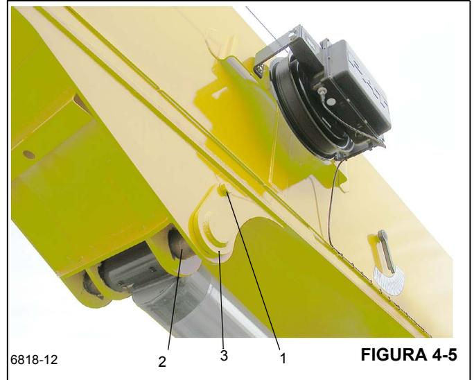
11. Remova o eixo do cilindro de elevação superior (Figura 4-5, 2).
