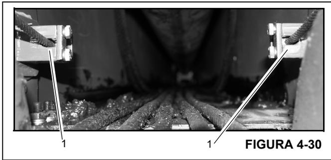
13. Remova o cabo de sincronização e o conjunto de polias da parte superior da seção intermediária externa.
