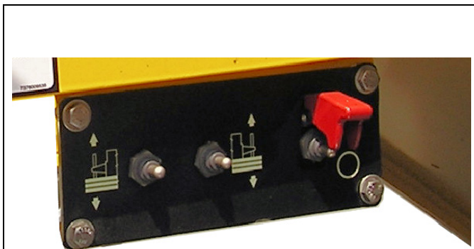
Interruptores de control de válvulas
