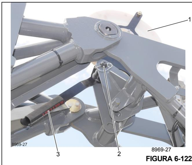
3. Pliegue la polea deflectora (1) y sujétela en esta posición con el pasador (2) (Figura 6-122).
