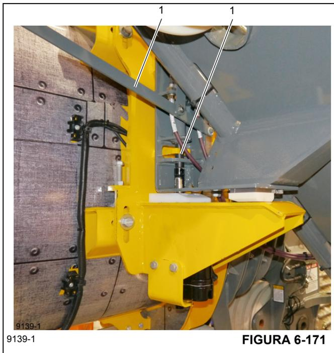
5. Verifique que el indicador del tubo N.º 1 (1, Figura 6-171) esté alineado con el indicador de la varilla cuando la extensión de la pluma esté almacenada en el costado de la pluma. Si está equipado con el indicador N.º 2, el indicador del tubo se debe ubicar de modo que
