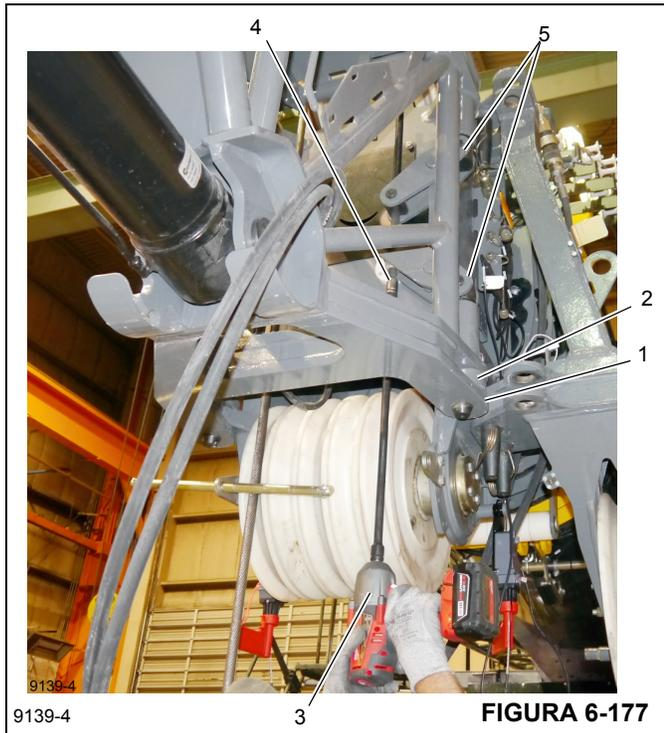
15. Usando la manija, pliegue la polea deflectora superior y asegúrela con el pasador. Asegure los pasadores con la pinza de retención.
