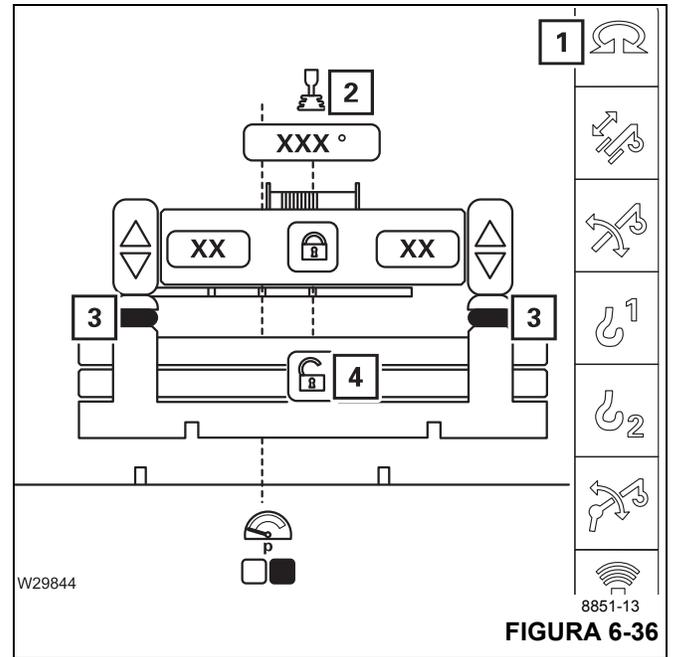
**Activación del modo automático**
