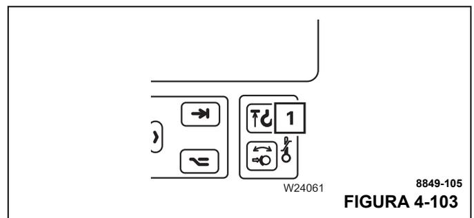
**Anulación del interruptor de prevención del contacto entre bloques**
