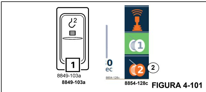
**Interruptor de prevención del contacto entre bloques e interruptor limitador de bajada**
