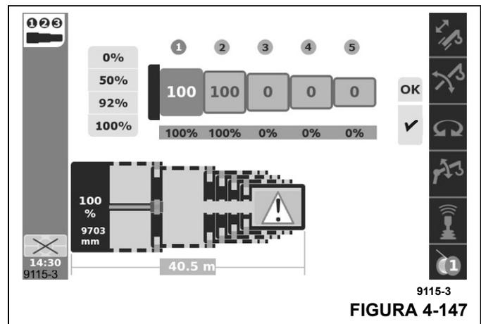
Por lo general, la condición de apagado indica una falla en los componentes del sistema de control (como sensores, módulos o comunicaciones). Si la única indicación de falla es para la función telescópica, pueden seguirse los pasos a continuación:
