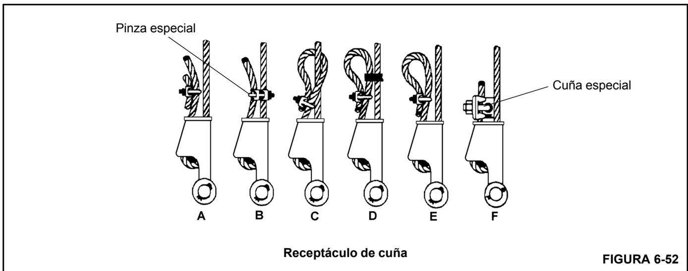
**Fijación del cable de elevación**
