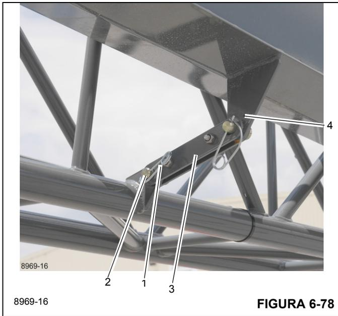
7. Retire la pinza de retención (1, Figura 6-79) del pasador (2) instalado en los adaptadores de fijación de la extensión de extremo y en los adaptadores de anclaje de la extensión base. Retire el pasador e insértelo en las argollas de almacenamiento en la extensión base, asegure con la pinza de retención.
