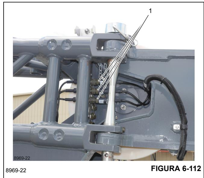
**Desconexión de las conexiones eléctricas de la extensión base de 58 pies (17.7 m)**
