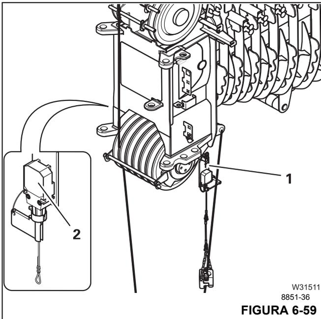
**Fijación del peso del interruptor de prevención del contacto entre bloques**
