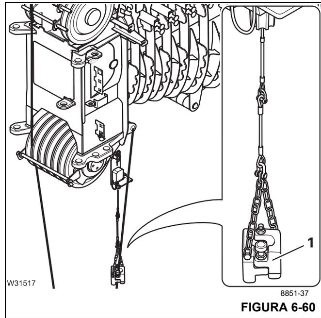
**Coloque un peso del interruptor de prevención del contacto entre bloques alrededor del cable de elevación**
