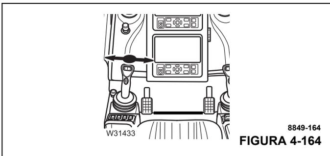
0° significa que la superestructura se ha girado hacia la pluma por parte trasera (Figura 4-165).
