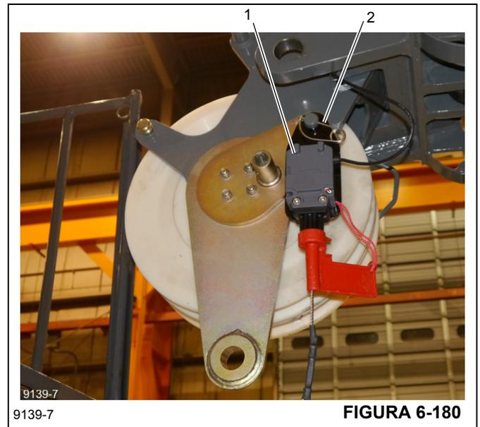
20. Conecte el cable de prevención del contacto entre bloques:
