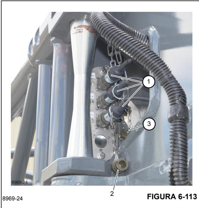
1. Retire los enchufes (1) (Figura 6-113) de los receptáculos y selle los enchufes con sus tapas (2). Selle los receptáculos con sus tapas (3).
