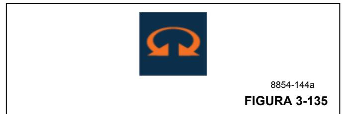
**Freno de giro conectado/desconectado**
