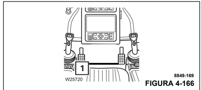
En la posición inicial, el movimiento de bamboleo se detendrá. Al mismo tiempo, se aplicará el freno hidráulico de la corona de giro.
