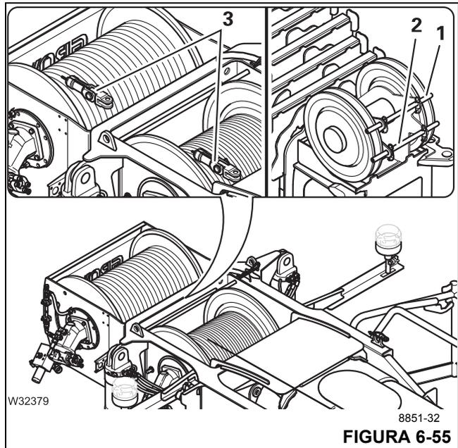
**Instalación/retiro del interruptor de prevención del contacto entre bloques**
