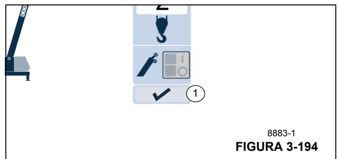
Cuando se selecciona la marca de verificación en la vista de configuración, el RDM regresa automáticamente al menú de monitoreo o al menú de verificación de estabilizadores.
