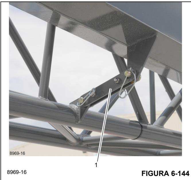
3. Empuje las palancas manuales de accionamiento horizontal del **Diseño A** (1, Figura 6-145) hacia la parte trasera de la pluma principal. Empuje las palancas manuales de accionamiento vertical del **Diseño B** completamente hacia abajo. Esto desengancha los pasadores que aseguran la extensión de extremo a la pluma principal.
