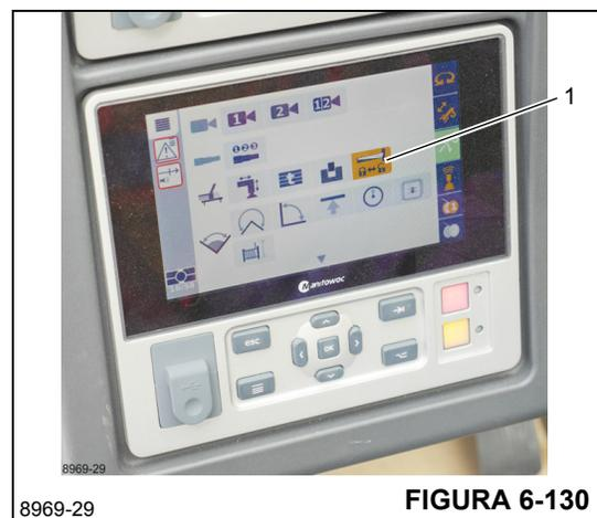
6. Seleccione el bloqueo del pasador N.º 2 (1) (Figura 6-131), los iconos del pasador N.º 2 se tornan de color verde (1) (Figura 6-134). La palanca (1) (Figura 6-132) debe moverse hacia arriba y los pasadores del cable (1) (Figura 6-133) deben retraerse de los pasadores de fijación (2).
