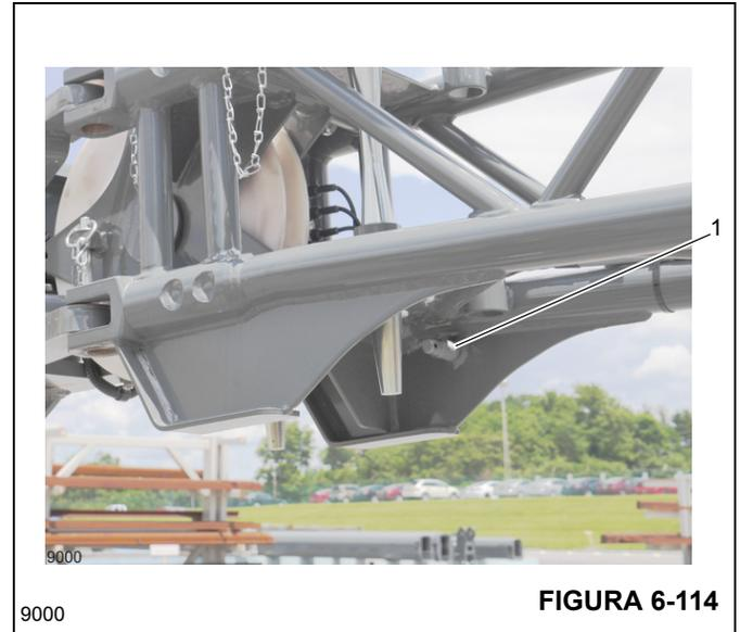
1. Instale el juego del interruptor de prevención del contacto entre bloques en el pasador (1) (Figura 6-114) y asegúrelo con una pinza de retención.
