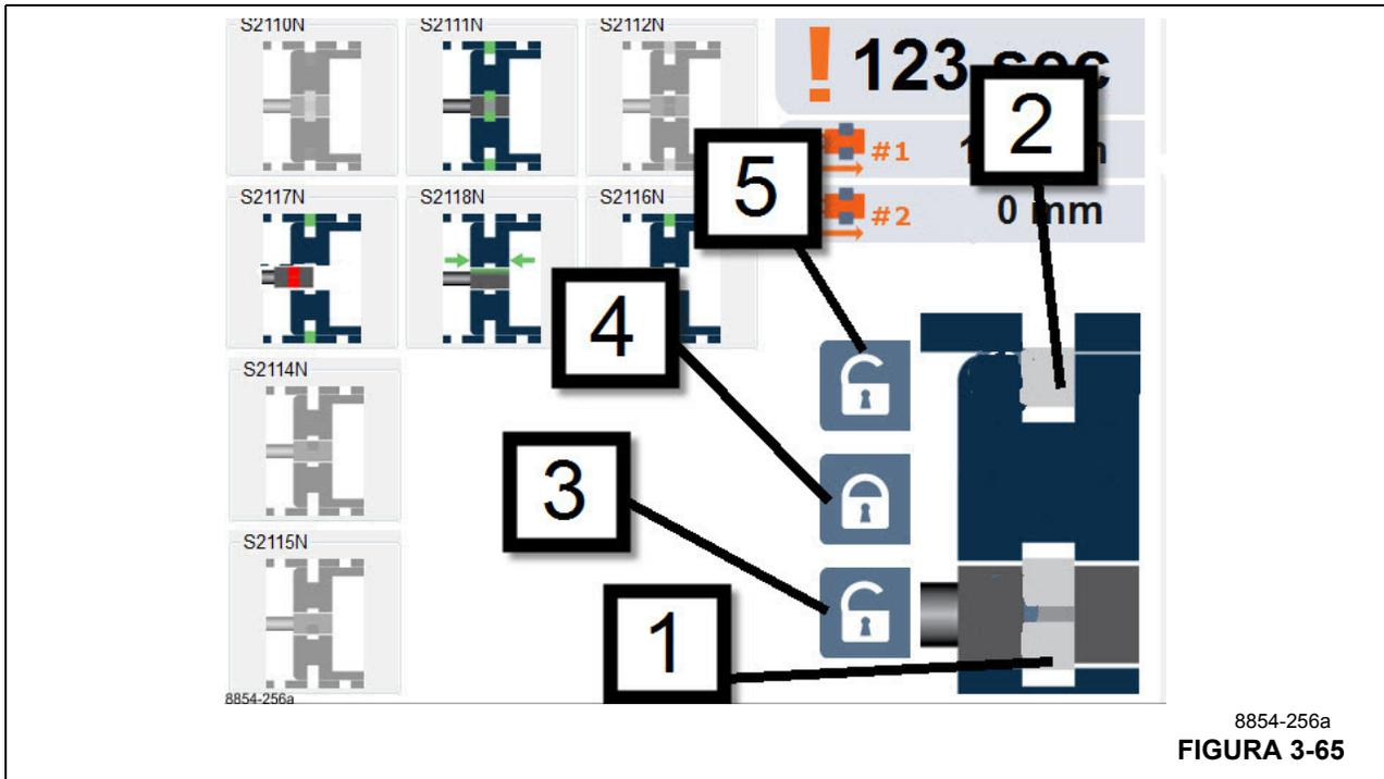
En la Figura 3-65 se encuentra una explicación más detallada de la vista del programa de emergencia de telescopización. El artículo 1 es la representación gráfica de los pasadores del cilindro telescópico que se conectan a la sección de pluma telescópica. Cuando estos pasadores de cilindro se consideran retraídos, un símbolo desbloqueado se mostrará en esta ubicación.
