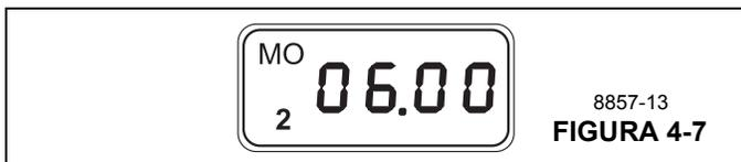
Ajuste la hora para el arranque de calefacción deseado, por ejemplo 8:00 – botón (6, Figura 4-2) o (7).
