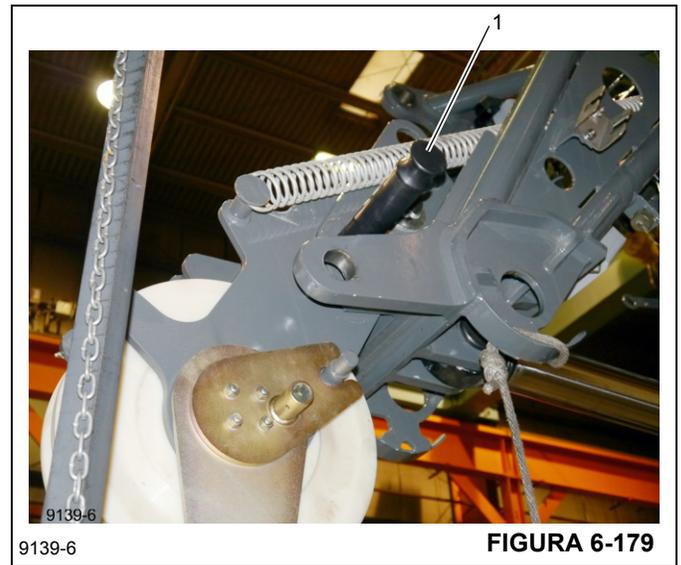
18. Según se necesite, coloque el cable de elevación principal o el cable de elevación auxiliar opcional para una configuración de cable de una a cuatro secciones.
