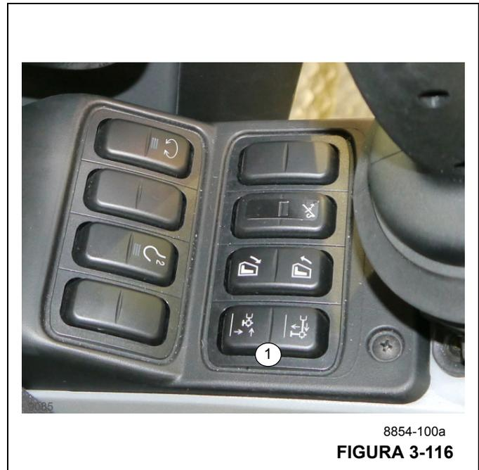
**Extender/retraer cilindros de gato de estabilizador**
