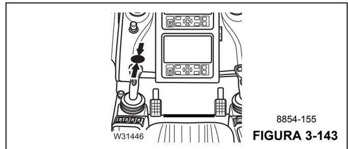
La palanca de control derecha se usa para elevar/bajar la pluma y elevar y bajar la extensión de pluma abatible.
