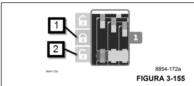
**Indicación de bloqueo/liberación de sección telescópica**
