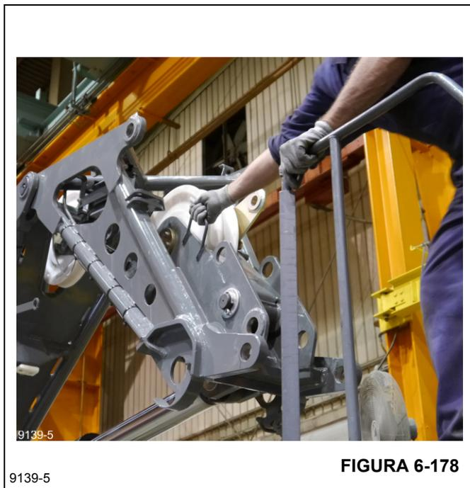
17. Asegure la polea con el pasador (1, Figura 6-179). Asegure los pasadores con la pinza de retención.
