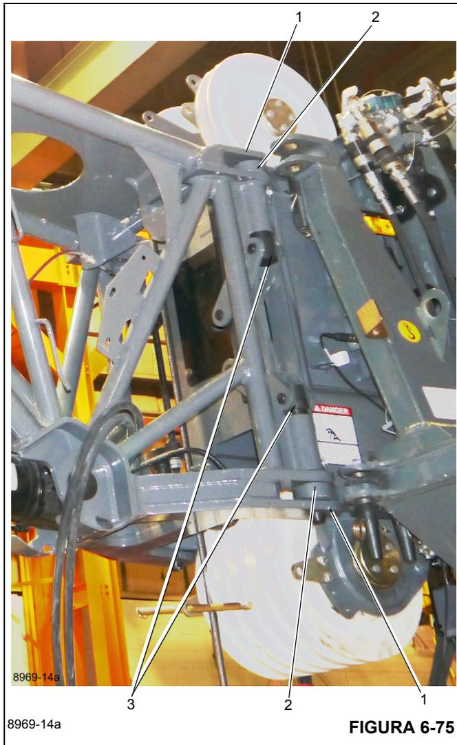
7. Instale los pasadores en ambos lados de la punta de la pluma (3, Figura 6-75) a través de los adaptadores usando un destornillador de golpe y girando el tornillo separador en sentido contrahorario.
