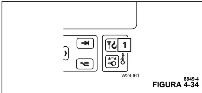
Si el interruptor de prevención del contacto entre bloques no está funcionando correctamente, no haga funcionar la grúa y notifique a su distribuidor local o a Manitowoc Crane Care; consulte *Dispositivo de prevención del contacto entre bloques*, página 2-5.
