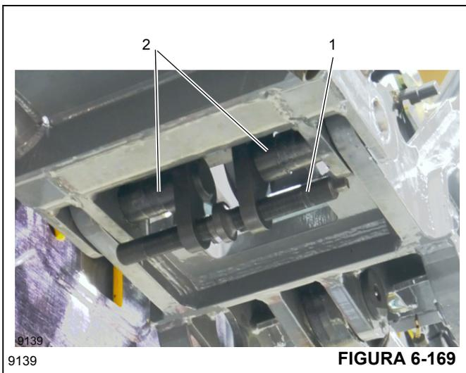
7. Usando el destornillador de golpe, gire el tornillo separador (1, Figura 6-174) en sentido contrahorario para desconectar los pasadores superiores (2) entre la extensión de pluma de servicio severo y la extensión base de celosía.
