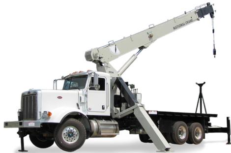
National Crane ofrece 8 modelos de grúas telescópicas de control con operador de pie con capacidades que van desde 9,1 t (10 T) a 29,9 t (33 T). El alcance vertical máximo varía de 17 m (56 pies) a 50,9 m (167 pies).
