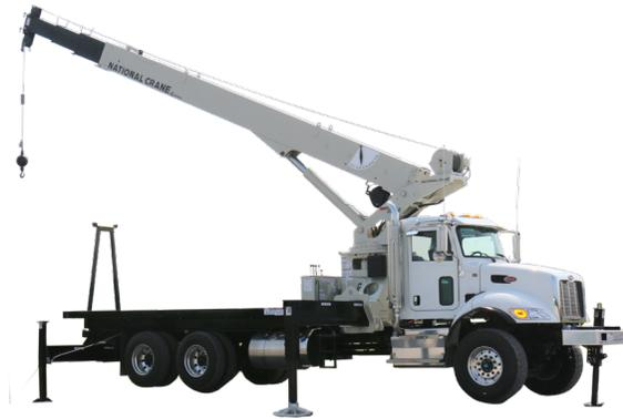
Las grúas de asiento giratorio ofrecen la comodidad y conveniencia de una cabina cerrada del operador. National Crane ofrece 14 modelos que van desde 27,2 t (30 T) hasta 54,49 t (60 T). El alcance vertical máximo varía de 49,7 m (161 pies) a 62,8 m (206 pies).
