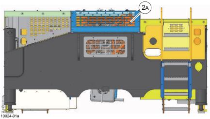
REAR VIEW OF CARRIER (COOLANT SITE GAUGE)
