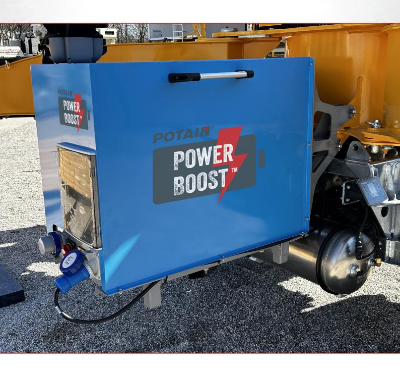
**Système autonome** d'alimentation électrique fonctionnant **sur batterie**
